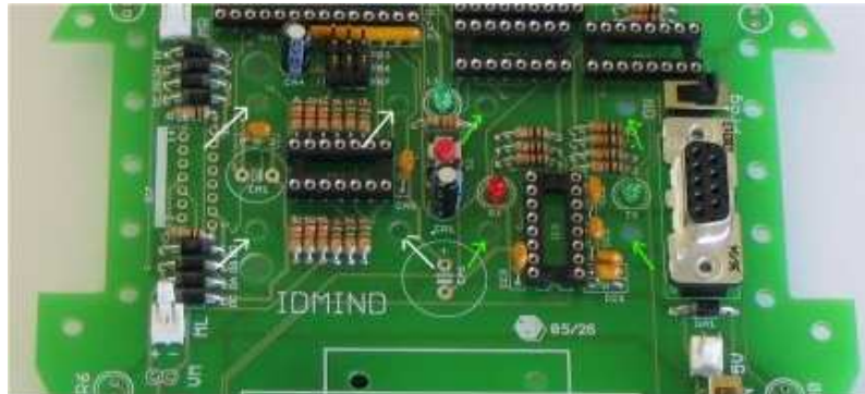
4.38- Locais de montagem dos motores
