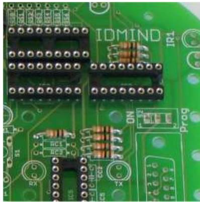
Fig. 4.18 - Montagem das Resistências de 10K \Omega .
