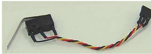
Fig. 4.42 - Montagem dos sensores de contacto
