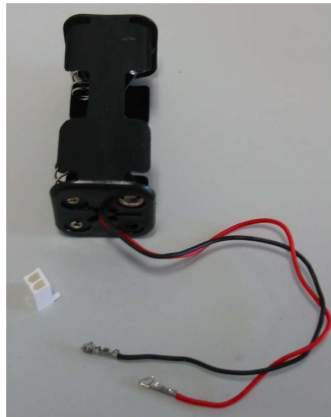
4.36- Montagem do suporte de Pilhas
