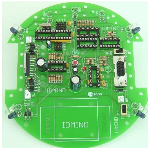
4.35- Montagem dos sensores de chão
