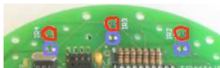
4.33 - Locais de montagem dos sensores de infravermelhos
